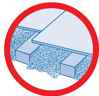
Die Wärmedämmschüttung für die lückenlose Dämmung von Hohlräumen. Rein mineralisch und ohne Chemikalien.
